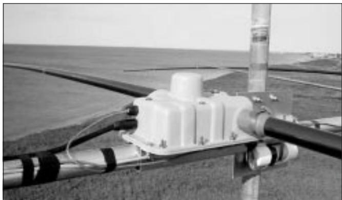
Napajalni del antene SteppIR 3-el. YAGI
