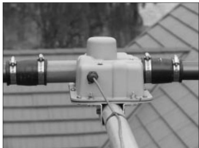
Napajalni del antene SteppIR 3-el. YAGI
