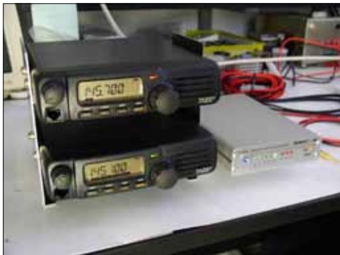
Slika 2 - Oprema repetitorja na Mrzlici med testiranjem
