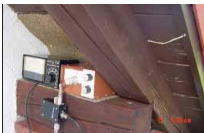
SWR-meter, antenski tuner in žični dovod do strehe (desno zgoraj).
