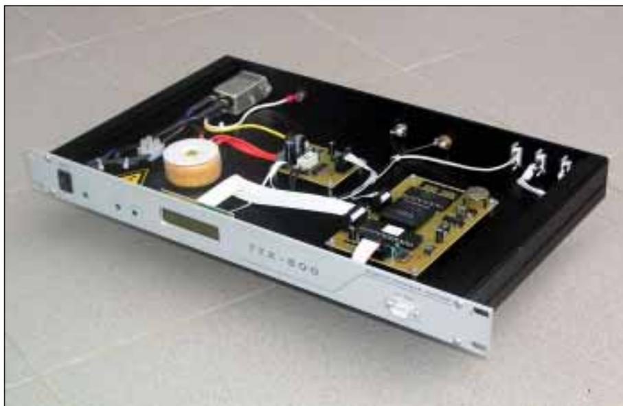
Slika 4 - Prototip sodobnega teletext generatorja
