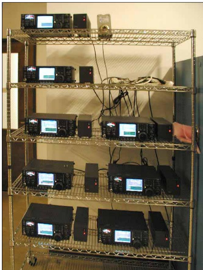
Slika 3 - Osem radijskih postaj IC 756ProII na testiranju za ekspedicijo 3Y0X. Postaje so preizkušene na zunanjih (delovnih) in notranjih test (v temperaturni komori do 0°C).
