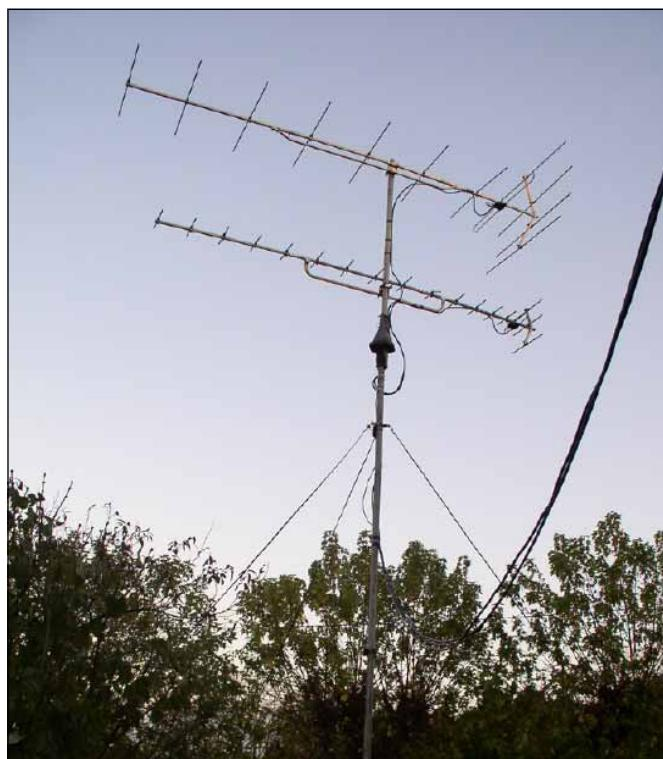
11-el. Yagi za 2m in 15-el. Yagi za 70cm, oboje Elrad
