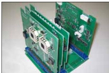
**ICE cube1**, izdelan na univerzi Cornell, ZDA, bo deloval na frekvenci 437.305 MHz (600 mW) FM, 9600 bps FSK AX.25, s klicnim znakom W2CXM.
