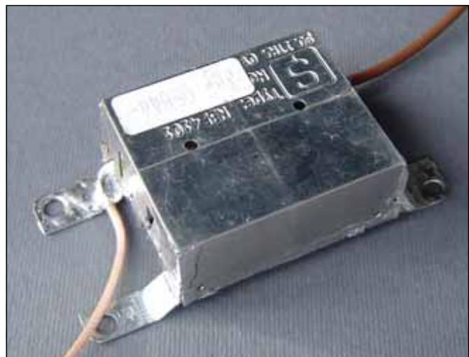
Slika 2 - Pasovno prepustni filter sprejemnika
