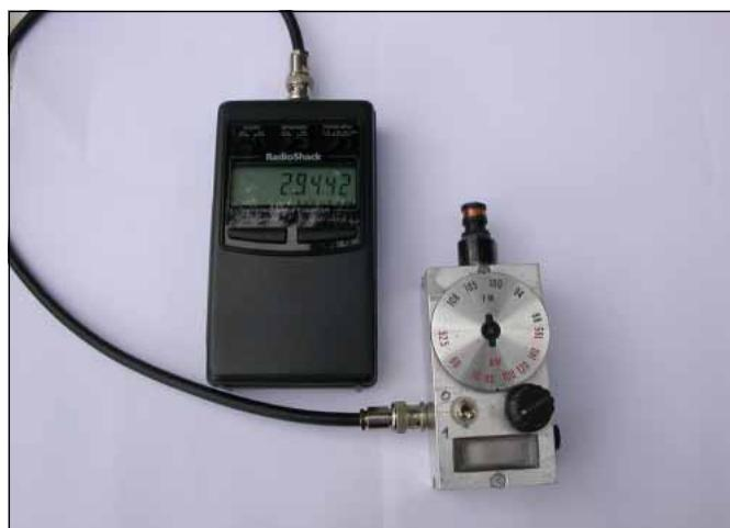
Izdelan grid-dip meter, povezan s frekvencmetrom
