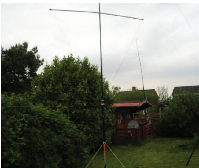
**Delta Loop antena za 50 MHz**
