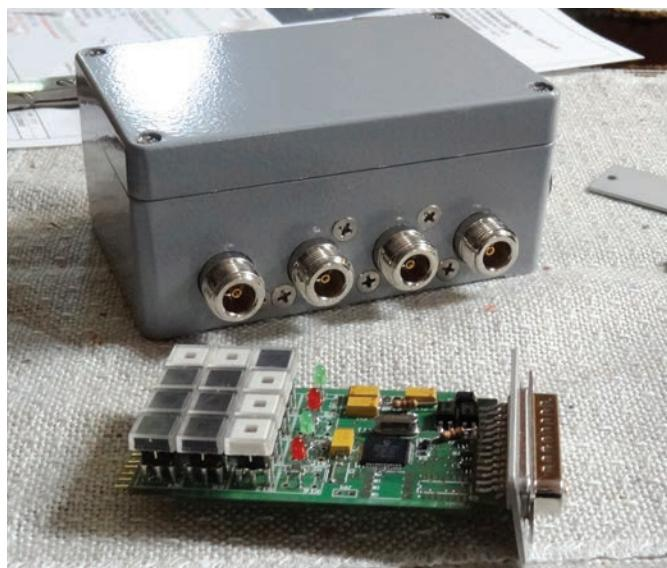
Slika 1 - Stari High Power antenski preklopnik - en vhod - trije izhodi (1/3) z elektroniko mini krmilnika
