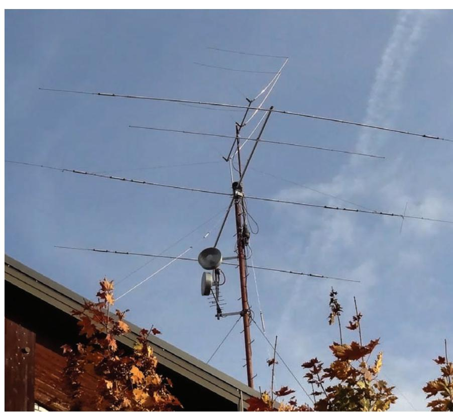
**Rezultat delovne akcije »Obnova antenskega sistema«: nov 3 EL delta loop za 6m, nov Cushcraft A4S + KIT za 7MHz (40/20/15/10m), ECO dipol (80/40/20/15/10m)**
