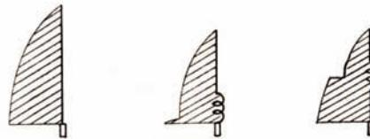
Slika 2: prikaz razporeditve antenskega toka na anteni dolžine četrtn lambda (levo), pri skrajšani verziji z podaljševalno tuljavo v podnožju antene (sredina) in pri skrajšani verziji, z podaljševalno tuljavo v sami anteni (desno).
