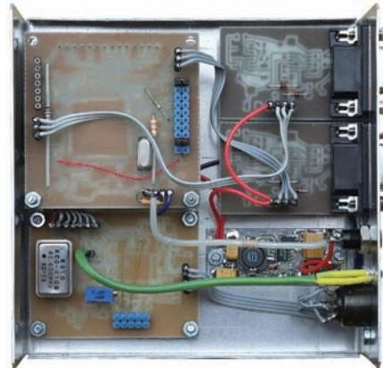
Pokrov je izdelan iz aluminijeve pločevine debeline 0.6mm in sega spredaj in zadaj 7mm preko robov dna ohišja. Na prednji plošči so DCD-LED in vse štiri vtičnice: radijska postaja, napajanje in dve RS-232:
