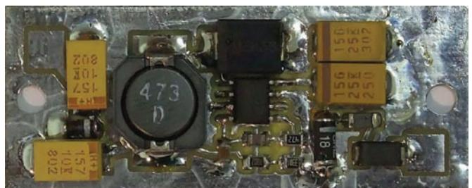
Napajalnik z L5973D je sicer predimensioniran tudi za uporabo v ASV. Smiselno ga je uporabiti za močnejše porabnike +5V, kot so nekatere IP kamere oziroma (brezžični) usmerjevalniki.
