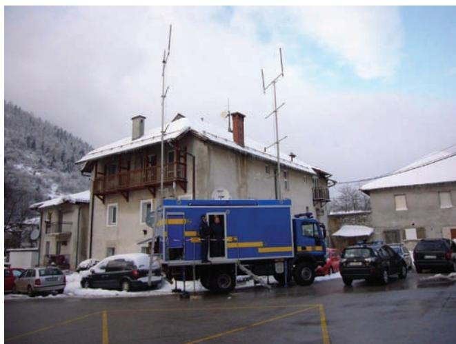
Slika 3 - Specialno vozilo za zveze EZIP
