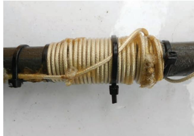
Slika 10 - Izgled izdelanega trapa
