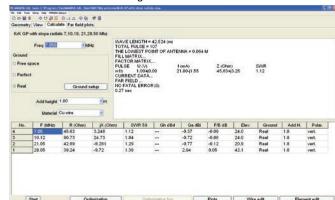
Slika 4 - Izračun parametrov vertikalne antene na različnih frekvenčnih območjih
