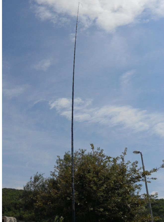
samonosilno vertikalno anteno iz ribiških palic dolžine do 7,7 m s trapom, ki bo prenesla tudi sunke burje preko 120 km/h.
