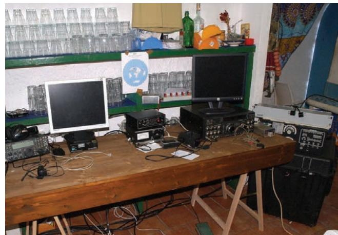
Slika 18 - Primer ureditve M/M pozicije enega od bandov. Postaja B, komande za rotor in M/M kontroler, postaja A, ojačevalec in HP BP filter. Pod mizo stack match za tri antene.
