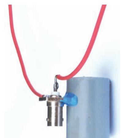
Spremenjena PVC spojka z pritrjenim BNC konektorjem.
