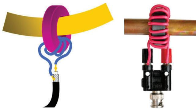
*Sklop s feritnim toroidnim transformatorjem - več sekundarnih ovojev*
