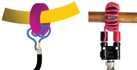
Izvedba sklopa s feritnim jedrom toroidnega transformatorja
