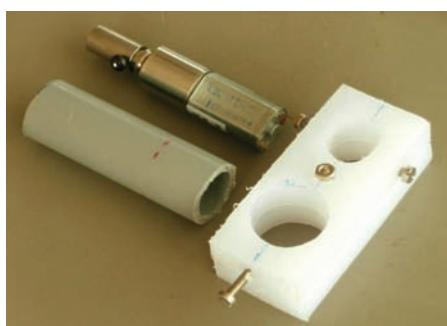
Izdelava nosilca za pritrditev PVC jambora in motorja
