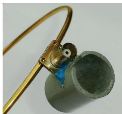
*Prav tako sem zamenjal sklop zanke z uporabo medeninaste cevke (premera 4mm). Ta je veliko bolj čvrsta, kot bakrena žica.*
