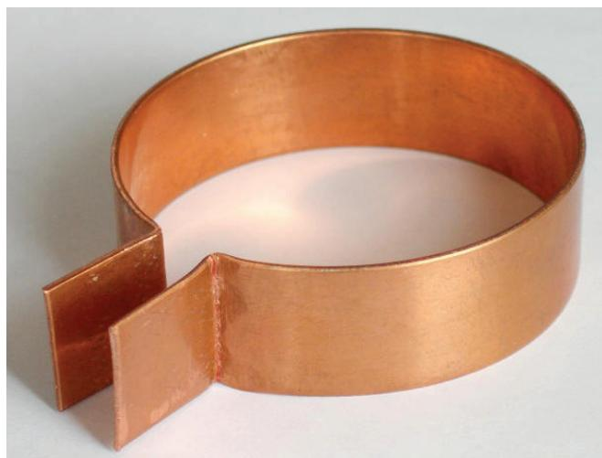
Objemka za pritrditev kondenzatorja z nosilcem, na-rejena iz bakrenega traku debeline 1 mm in širine 20 mm
