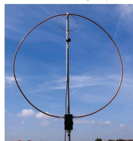
Kasneje sem spremenil način pritrdirtev bakrene cevi na vrhu droga.
