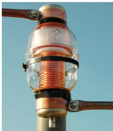
Nov način pritrditve vakuumskega kondenzatorja
