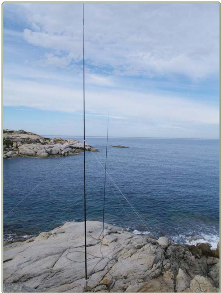
Zel 40m vertikalna antena v smeri NA
