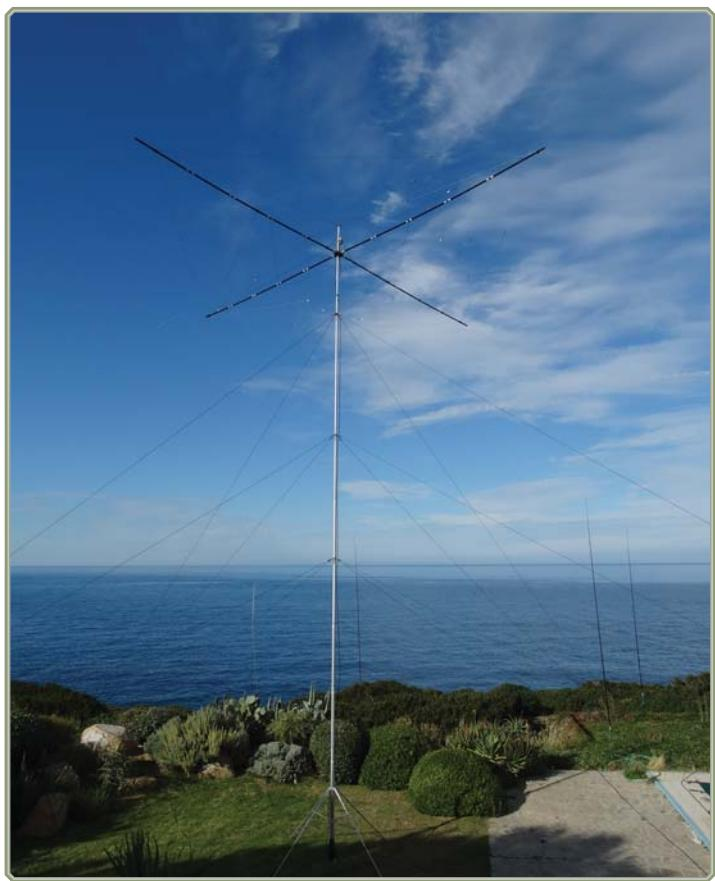
Spiderbeam in 4SQ fazirane vertikalne antene
