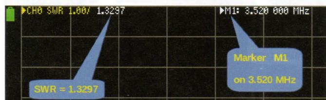
Vodoravne in navpične črte so nekakšen nadomestek osi x in y. Navpične črte samodejno prilagodijo nastavljeni frekvenčni razpon na enake dele, kot vidimo na dnu zaslona (slika 20). Merska enota lestvice vodoravnih črt. Lestvico enote nastavimo kot najprimernejšo glede na vrsto meritve.
