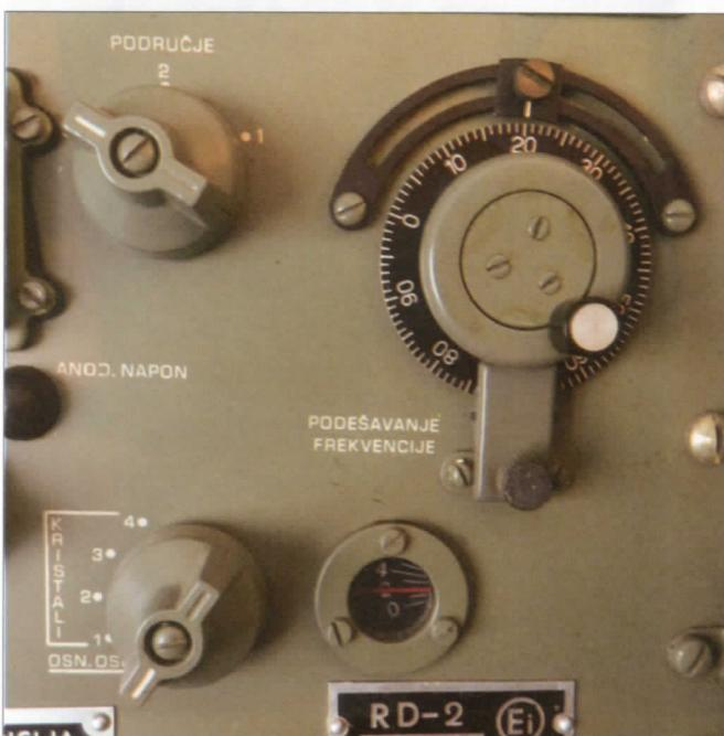
Oddajna frekvenca je nastavljena na 3,55 MHz
