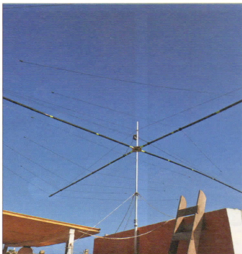
Slika 15: Na travniku pod zidom apartmaja smo postavili vertikalko za 7 MHz, na terasi apartmaja pa Spider beam za 10, 15 in 20 m na ročno obračanje.
