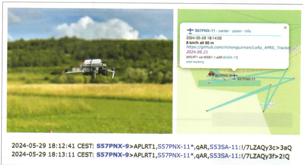
Slika 6: Sledilnik S57PNX-11 na letalniku, njegova sled na zemljevidu in prikaz digipetiranja postaje S5PNX-9 v avtu
