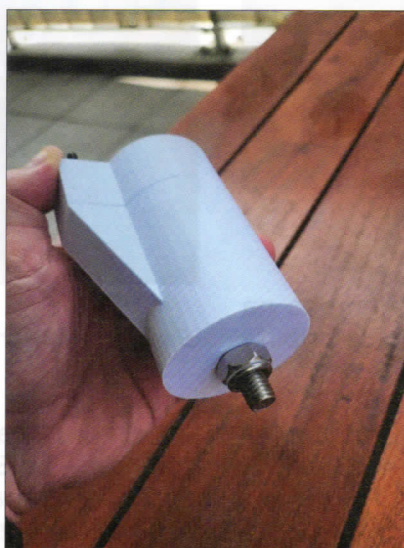
Slika 11: Zategnjena samozatezna matica na spodnjem delu škatlice
