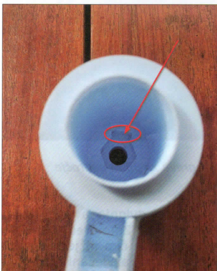
Slika 10: Žleb za vpeljavo tuljavne žice pod glavo M10 vijaka
