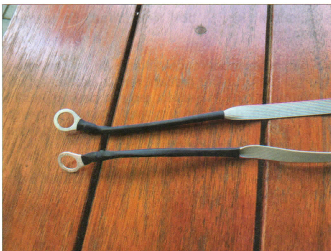
Slika 13: Priprava računalniških ploščatih kablov za uporabo kot radiale na anteni
