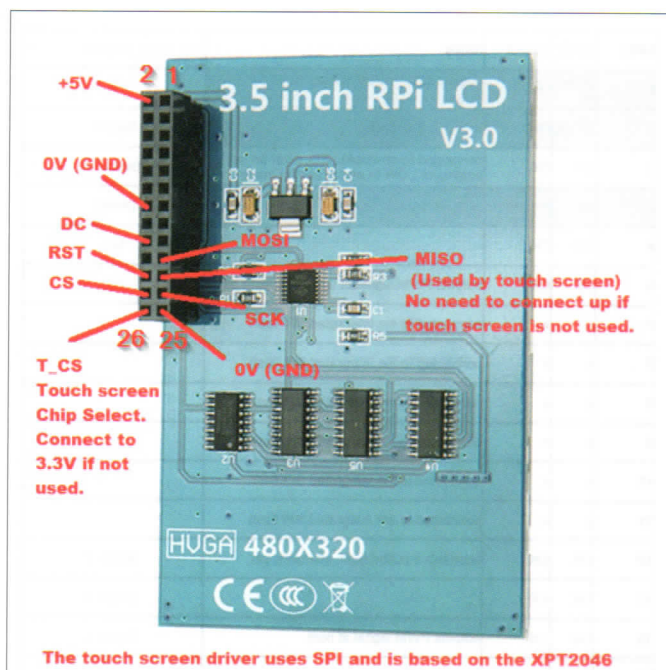
Slika 6: Hrbtna stran LCD z razporeditvijo priključkov
