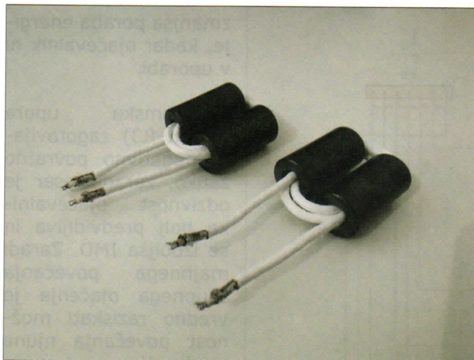
Dve strani širokopasovnega 1:9 TLT transformatorja
