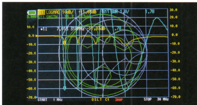
Slika 2: Prikaz odziva vertikalne antene s trapi
