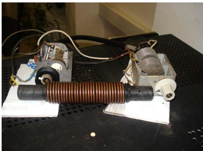
Slika 1: Provizorični Pi filter
