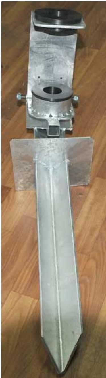
Mehanična konstrukcija spodnjega dela je izvedena iz »L« profila 70x70. Gornji del konstrukcije je pritrjen na osnovo. V gornjem delu so izdelane odprtine fi 90 mm v katere so nameščeni izolatorji. Izolatorji imajo izvrtine v katere se namesti spodnji del antene. Izolatorji so narejeni na stružnici in so iz kvalitetne plastike. Celotna spodnja konstrukcija je vroče cinkana za čim daljšo življenjsko dobo.
